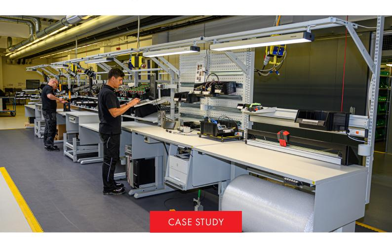
Schlanke Produktion im One-Piece-Flow - flexible Fertigung von Drahtvorschubeinheiten auf Concept-Arbeitstischen von Treston
